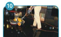
В конце каждого прохода разворачиваться так, чтобы кабель располагался на уже очищенной зоне. По каждой зоне дважды проходить внахлест (перекрывающими движениями).
