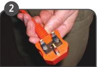
Проверить оборудование, особенно вилку и кабель. О любой неисправности или повреждении сообщить руководителю. Пометить оборудование, как неисправное и не использовать до полной проверки/ремонта
