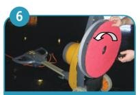
Наклонив машину назад, положить ручку на пол. Установить аксессуары. Повернуть защелку против часовой стрелки для фиксации.
