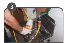
Для спрейной полировки заполнить спрейную бутылку соответствующим моющим раствором.
