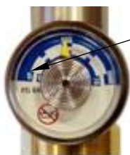
Рисунок 23 – Манометр на редукторе баллона
