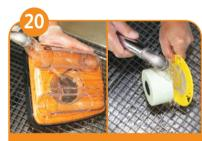
Промыть чистой водой крышку и поплавок.
