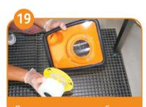
Отсоединить крышку бака с грязной водой от шлангов
