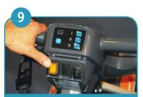
Включить машину, нажав кнопку "ВКЛ/ВЫКЛ"/
