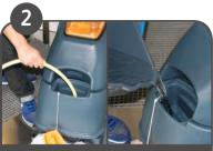
Заполнить бак чистой водой с помощью заливного шланга, используя ведро или дозирующую систему.
