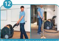
Приступить к уборке пола машиной <u>либо с помощью набора для ручной</u> уборки. Рычаги на ручке включают щетку и подают моющий раствор. ВНИМАНИЕ: оператор может работать в двух направлениях: тянуть или толкать машину.
