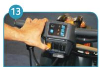
По окончании работы выключить машину, нажав кнопку "ВКЛ/ВЫКЛ" на приборной панели.
