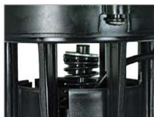
ЭЛЕКТРИЧЕСКИЙ ВСТРЯХИВАТЕЛЬ ФИЛЬТРА
