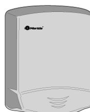
Эта модель срабатывает при поднесении рук к сенсору. Расстояние при котором электрическая сушилка будет автоматически включаться – около 10-15 см. (3/8-9/16") от выходного раструба. Автоматической выключение происходит через 2-3 секунды, после убирания рук. Если сенсор разбит вследствие небрежного использования, электрическая сушилка работать не будет.
