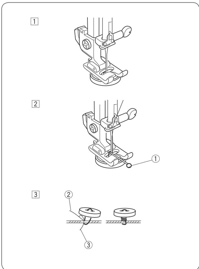
① Удалите нить из иглы. Измените ширину зигзага так, чтобы игла сквозь прорезь на лапке попадала в отверстия пуговицы. Поверните маховое колесо и проверьте, входит ли игла в отверстия пуговицы. Опустите прижимную лапку, чтобы закрепить пуговицу на месте. Отверстия в пуговице должны совпадать с прорезью на лапке.
