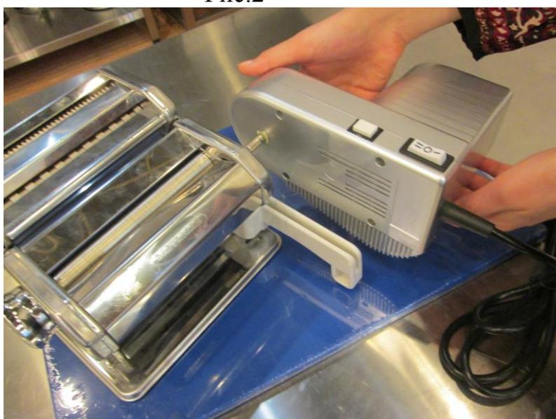
Отпустить кнопку и вдавить двигатель так, чтобы он оперся на машину.
