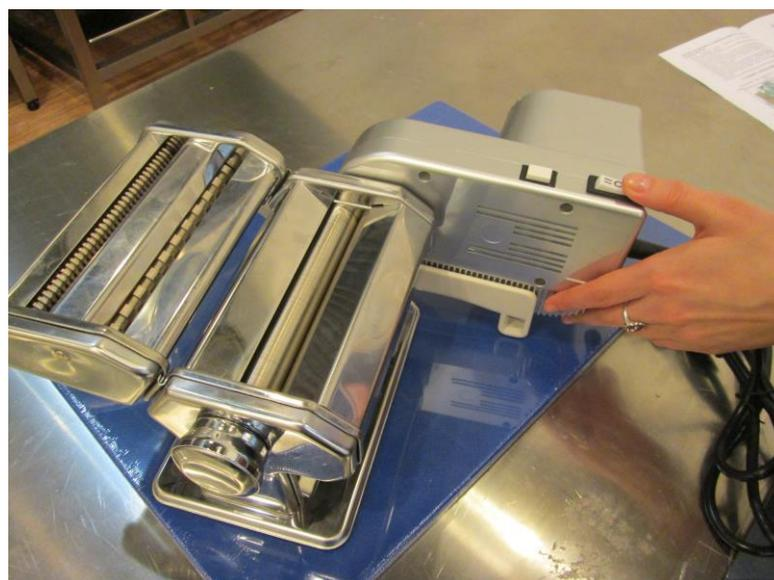
Чтобы отсоединить двигатель от машины, повернуть его вверх на угол приблизительно 30° и вытянуть наружу.
